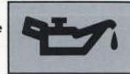
Esta luz es de color rojo y se enciende al colocar la llave de contacto en la posición II (encendido). La luz debe apagarse inmediatamente después que el motor se ponga en funcionamiento, no debiendo encenderse mientras el motor funciona: **LA LUZ APAGADA INDICA CON CERTEZA QUE LA PRESION DE ACEITE DEL MOTOR ES CORRECTA (SI LA LAMPARA Y EL CIRCUITO FUNCIONAN CORRECTAMENTE).**
