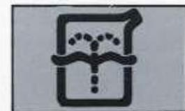
Esta luz se encenderá cuando el nivel del líquido en el depósito del lavaparabrisas ha llegado a la marca de mínimo. Complete el nivel de acuerdo a lo indicado en la sección "Cuidado de su vehículo"
